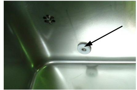
Bild 3: Fühler der Wasserstandregulierung
