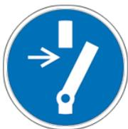
**Achtung:** Vor dem Auseinandernehmen von Bauteilen oder dem Freilegen von Drähten muss die Stromversorgung am Netz-Trennschalter ausgeschaltet und die Sicherung entfernt werden. Beim Testen ohne Deckplatte muss darauf geachtet werden, dass eine Berührung stromführender Anschlussklemmen vermieden wird.
