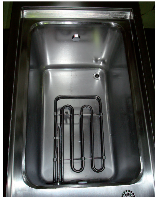
Bild: Ansicht Heizung
